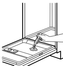
Cuando utilice pastillas múltiples con sal y abrillantador, no es necesario llenar el depósito de sal ni el dosificador de abrillantador.
