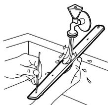
Lave o braço aspersor em água corrente. Utilize um objecto fino e pontiagudo, por exemplo um palito, para remover a sujidade dos orifícios. Faça correr água através dos orifícios para lavar partículas de sujidade do interior.
