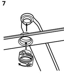
Inserte el elemento de montaje en el brazo aspersor y fíjelo en el tubo de entrega girándolo en el sentido de las agujas del reloj. Asegúrese de que el elemento de montaje encaje en su sitio.
