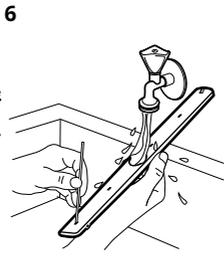
Lávalo con agua corriente. Retire las partículas de suciedad de los orificios mediante un objeto afilado, como un palillo. Pase el agua a través de los orificios para quitar las partículas de suciedad del interior.
