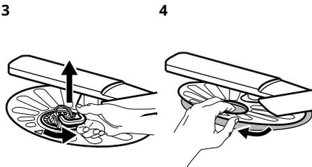
Para retirar los filtros (B) y (C), gire el asa en la dirección opuesta a las agujas del reloj y tire hacia arriba. Extraiga el filtro (C) del filtro (B). Lave los filtros con agua.
