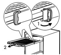
Libere los topes en los lados de los rieles deslizantes del cajón de cubiertos y saque el cajón.
