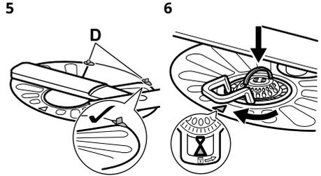
Vuelva a colocar el filtro plano (A). Asegúrese de que está colocado correctamente en las dos guías (D).
