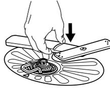
Para instalar el brazo aspersor de vuelta, presiónelo hacia abajo.
