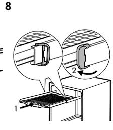
Instale el cajón de cubiertos en los rieles deslizantes bloqueando los topes.
