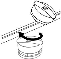
Gire la tapa del depósito de sal hacia la derecha para cerrar el depósito de sal.
