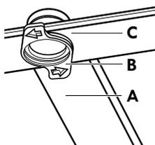
O braço aspersor (C) está instalado no tubo de entrega (A) com o elemento de fixação (B).
