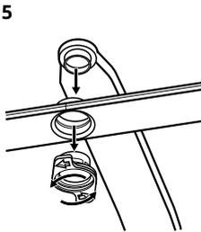
Gire el elemento de montaje en el sentido contrario a las agujas del reloj y tire del brazo aspersor hacia abajo.
