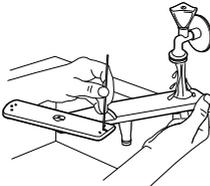
Lávelo con agua corriente. Retire las partículas de suciedad de los orificios mediante un objeto afilado, como un palillo.
