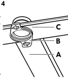
El brazo aspersor (C) está instalado en el tubo de descarga (A) con el elemento de montaje (B).
