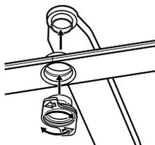
Insira o elemento de fixação no braço aspersor e fixe-o no tubo de entrega rodando-o para a direita. Certifique-se de que o elemento de fixação bloqueia no lugar.
