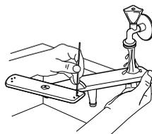
Lave o braço aspersor em água corrente. Utilize um objecto fino e pontiagudo, por exemplo um palito, para remover a sujidade dos orifícios.
